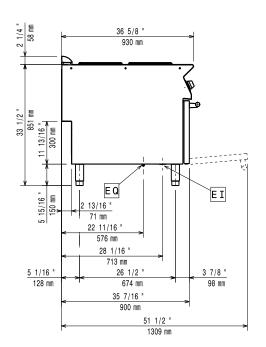
Electrical inlet (power) EQ Equipotential screw
